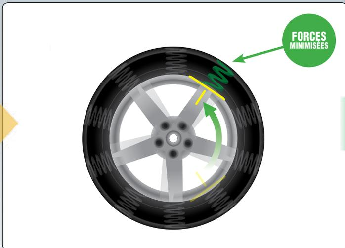
L'équilibreur Road Force utilise les méthodes d'appariement des pneus/jantes utilisés par les fabricants OE.
