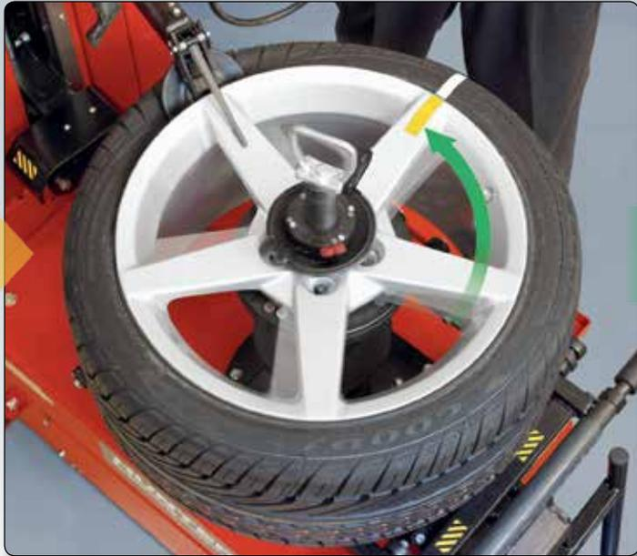
Un montage ajusté du point le plus rapide du pneu au point bas de la jante, rend l'assemblage aussi rond que possible
