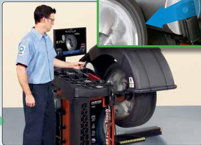
Le rouleau de charge mesure la force de route pendant que le technicien prépare les pesées
