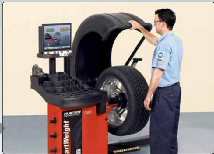
Le technicien soulève le carter manuellement, installe les pesées et procède à la vérification de l'équilibrage
