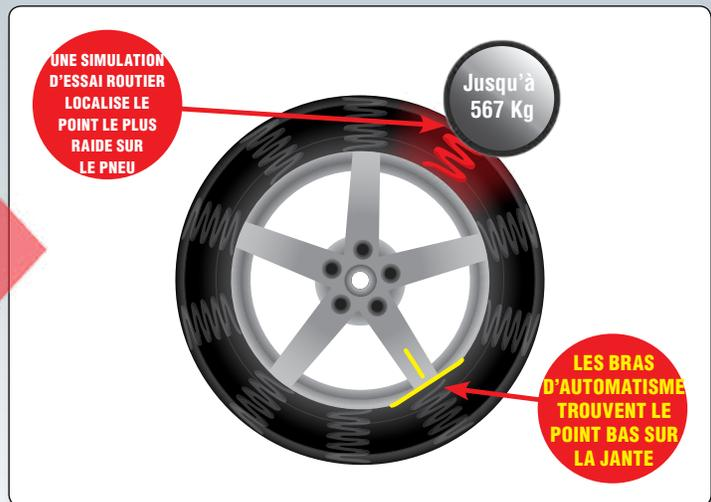
L'équilibreur Road Force Tactile détecte les forces radiales à l'aide d'instruments sensibles
