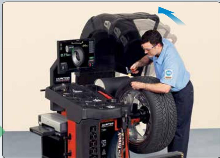
Le capot de sécurité est soulevé automatiquement pour l'installation des pesées par le technicien et pour la vérification
