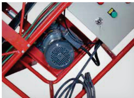
Moteur du convoyeur 1 HP ou 1,5 HP (selon le modèle de convoyeur)
