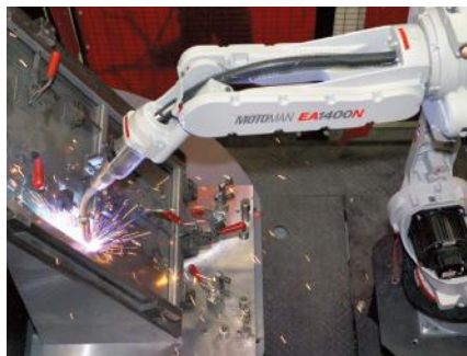
Soudure robotisée pour les produits standards et les projets de volume.
